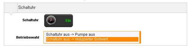
Die Betriebswahl ist auf Schaltuhr mit reduziertem Sollwert eingestellt, was eine Absenkung der Temperatur ausserhalb der eingegebenen Zeiten entspricht.
