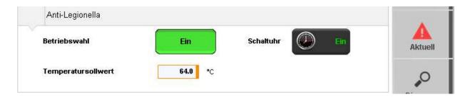
Mit der Wochenschaltuhr wird der Wochentag, an dem die sogenannte "Legionellen-Schaltung" aktiviert wird, festgelegt. Diese "Legionellen-Schaltung" bewirkt das die Bakterienbildung welche zur "Legionärskrankheit" führt Einhalt geboten wird durch kurzzeitiges überhöhen der Wassertemperatur (64°Cels.).
