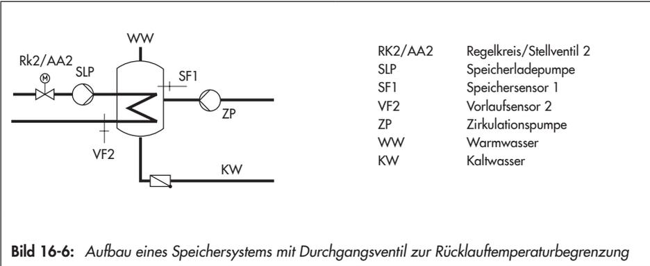
Durchgangsventil und Temperatursensor VF2 dienen in der oben dargestellten Schaltungsvariante ausschließlich der Rücklauftemperaturbegrenzung. Der Vorregelkreis stellt wie in der Standard-Schaltung mindestens eine Vorlaufemperatur zur Verfügung, die sich aus 'Sollwert Trinkwasser' + 'Überhöhung Ladetemperatur' + 'Überhöhung Sollwert Vorregelkreis' ergibt.
